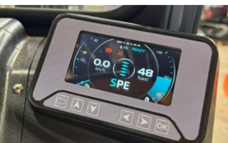
L'état du véhicule toujours sous les yeux grâce au tout nouvel écran couleur numérique. De série sur les modèles FLB.
