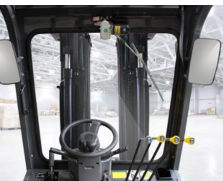
Pare-brise avec essuie-glace et toit en plexiglas, inclus d'usine !
