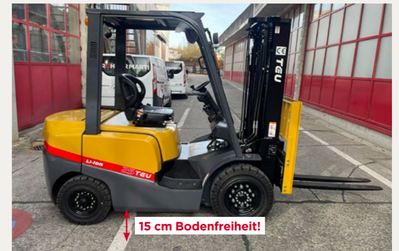
Viel Bodenfreiheit dank den grossen Rädern. Optimal für kombinierte Ausseneinsätze mit unebenen Böden und Absätzen.
