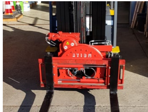
Die TEU FLB Stapler verfügen serienmässig über vier Hydraulik-Kreise inklusive Seitenschieber. Damit sind sie sofort für vielfältige Anbaugeräte bereit und ermöglichen präzises, effizientes Arbeiten ohne zusätzliche Nachrüstungen.
