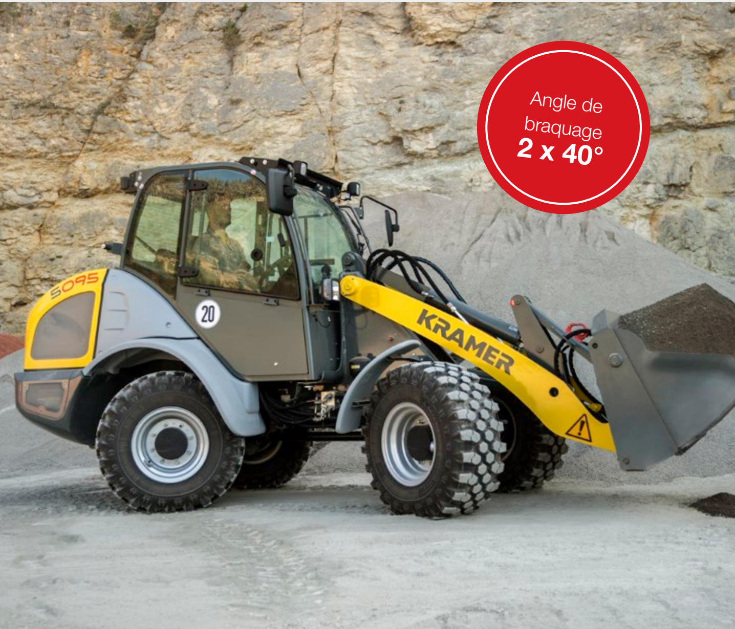
Quatre roues directrices pour une grande maniabilité, en particulier dans des conditions d'espace limité
