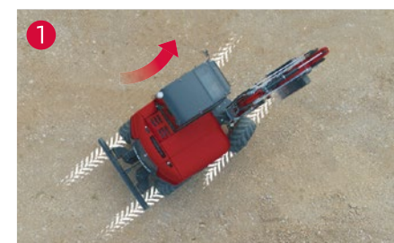
1 Direction des roues avant idéal pour la conduite sur route
