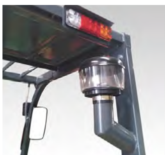
Filtre à air sur le montant de toit (avec préséparateur)
