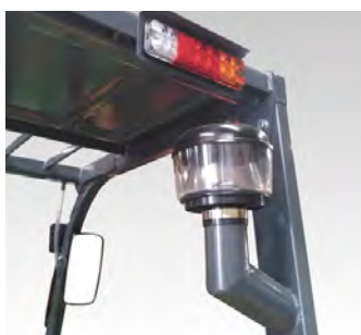
Luftfilter am Dachpfosten (mit Vorabscheider)
