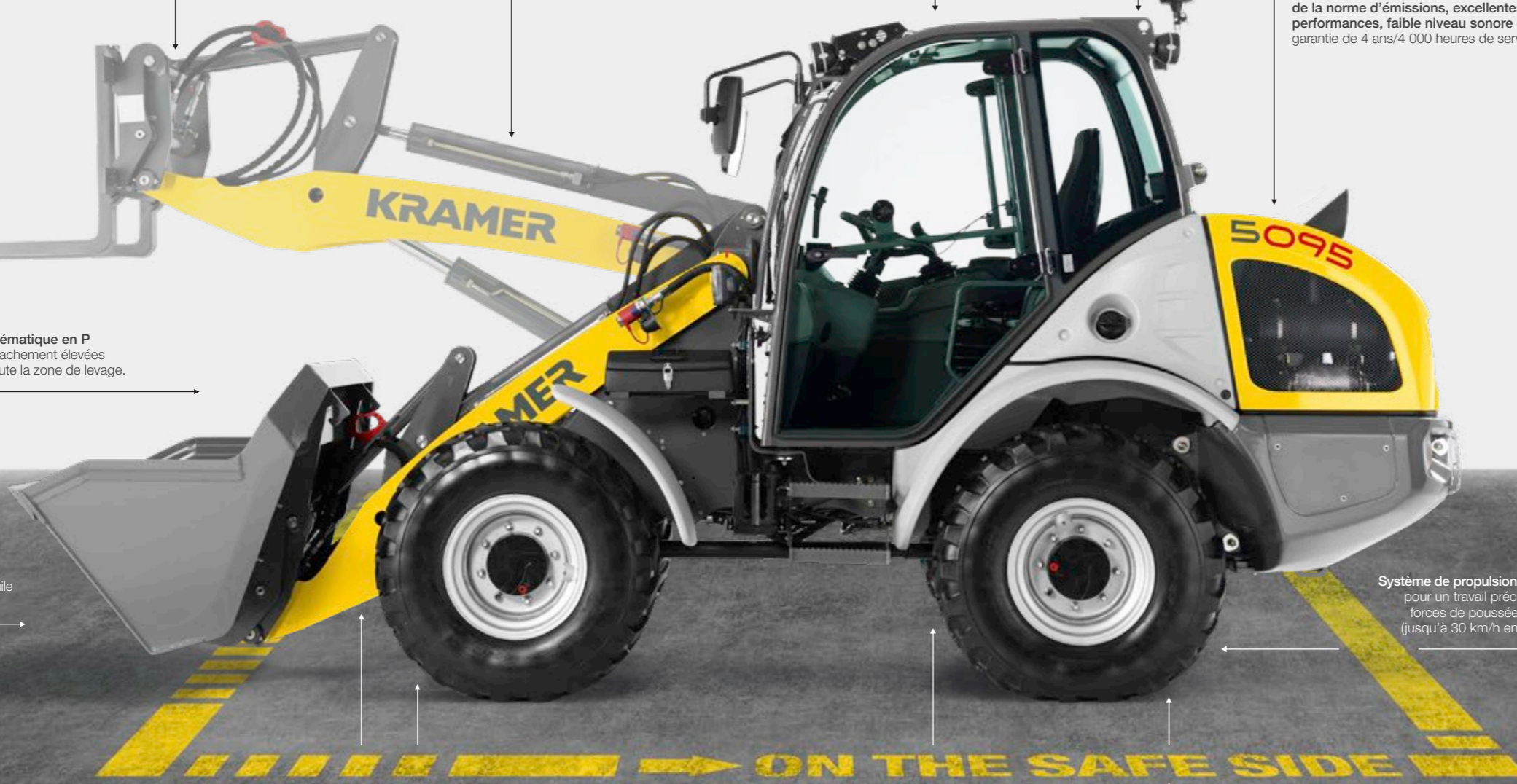
Système de direction unique avec trois modes de direction : quatre roues directrices (standard), direction marche en crabe et par essieu avant (option).
