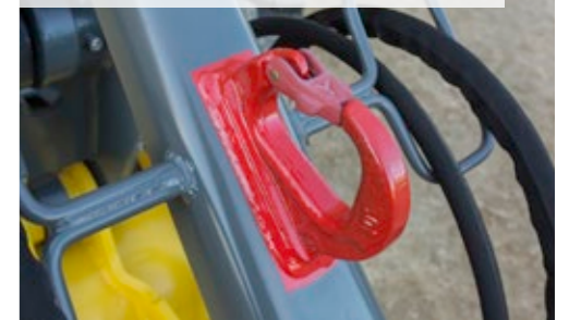
Crochet de levage sur la barre de cavage (standard)
