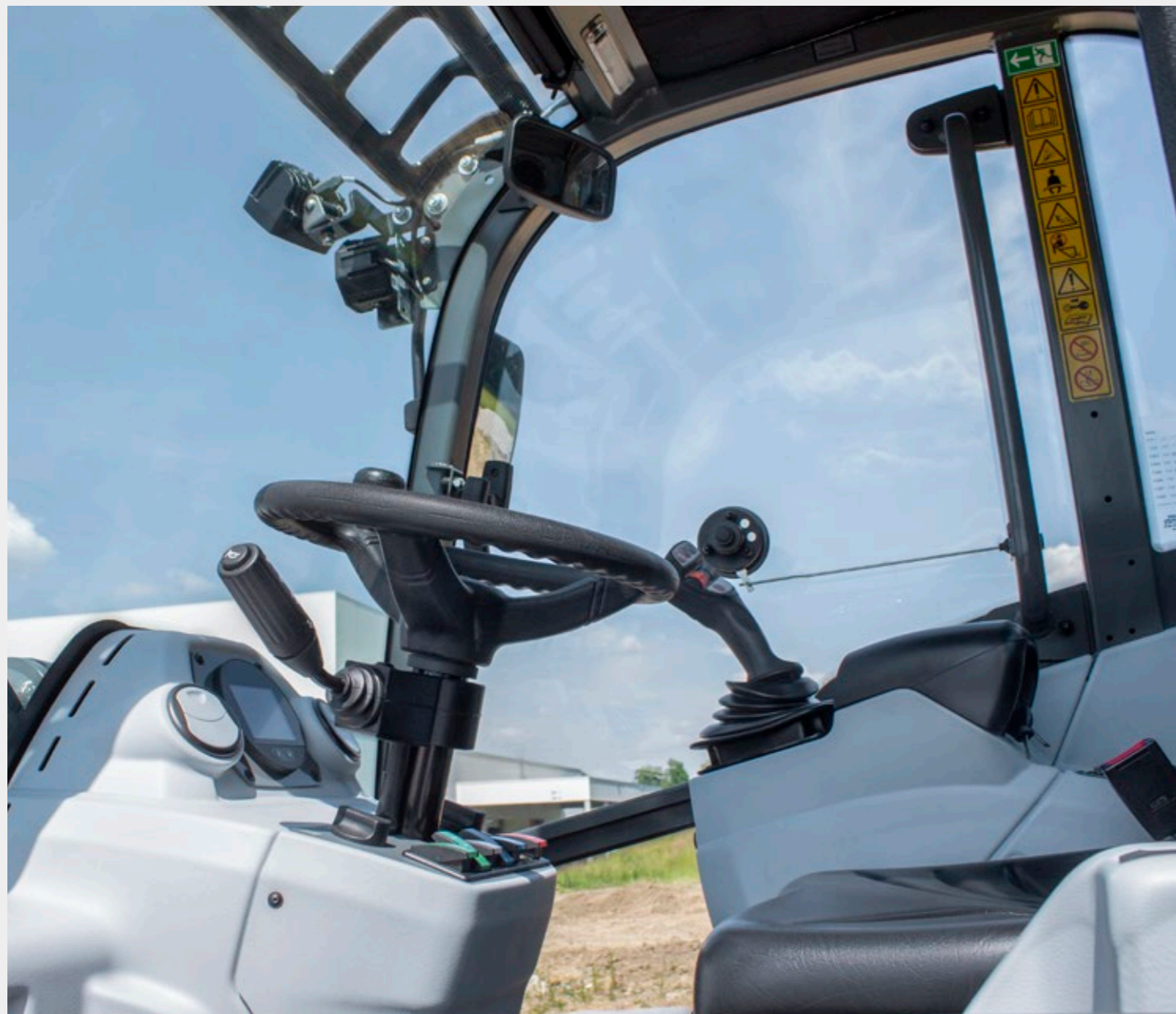
Rundum verglaste Kabine für eine optimale Sicht zu allen Seiten.
