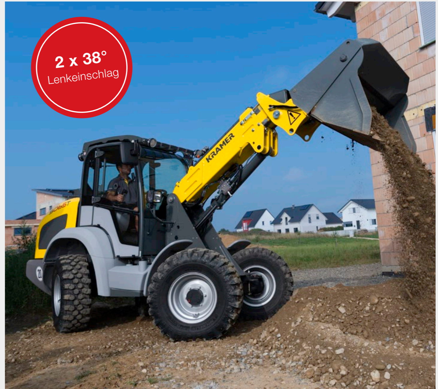
Allradlenkung: besonders wendig bei eingeschränktem Platz
