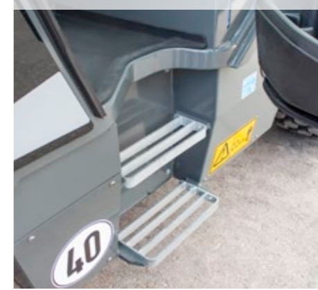
Accès cabine avec renforcement
