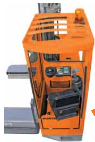
Cabine à siège diagonal avec siège pivotant (DS 770)
