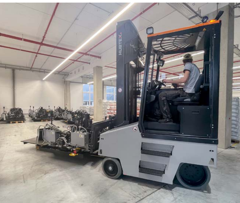
Patentierte HX-Mehrwegelenkung für einzigartige Manövrierfähigkeit
