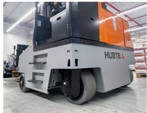
Patentierte HX-Mehrwegelenkung für einzigartige Manövrierfähigkeit
