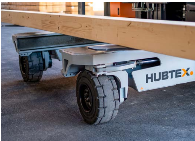
Während eines Richtungswechsels wird automatisch die Feststellbremse aktiviert.
