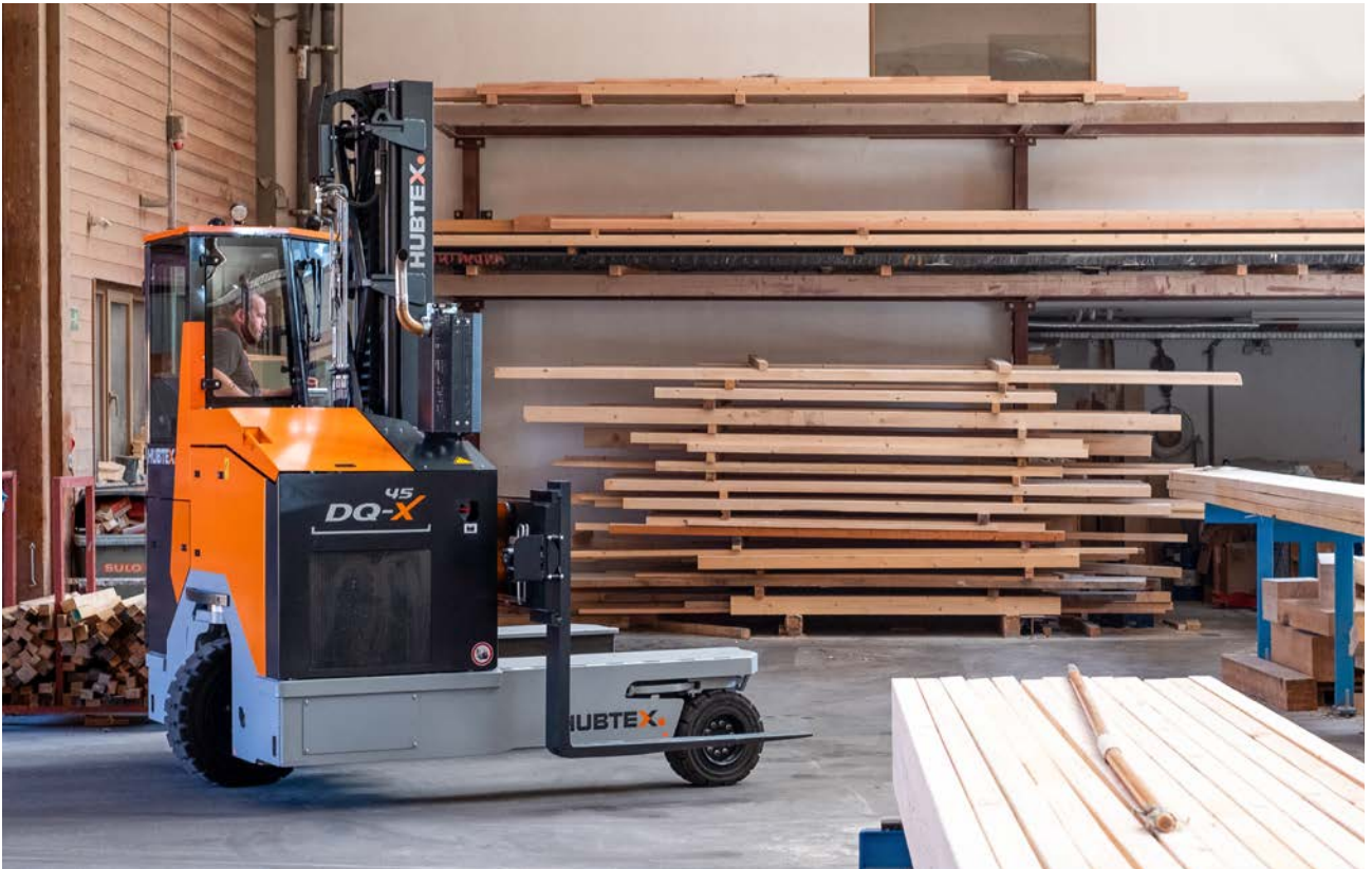
Der innovative Stabilisierungs-Assistent verhindert unerwünschte Schaukelbewegungen bei starkem Bremsen.
