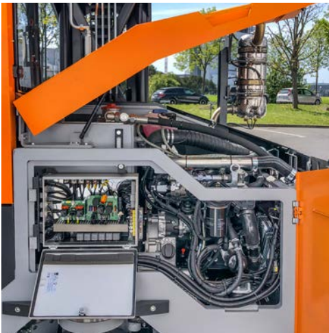
Geräuschoptimierter Turbomotor analog aktueller Abgasnorm
