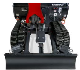
Eingefahrener Unterwagen : 980 mm
