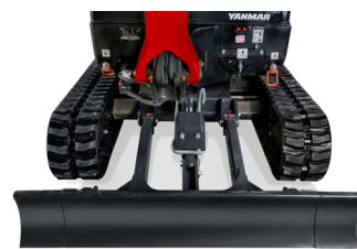
Ausgefahrener Unterwagen : 1 380 mm
