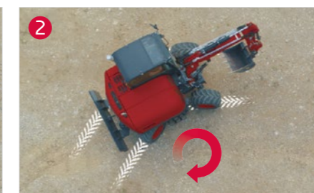
2 Allradlenkung kleiner Wenderadius auf engen Baustellen
