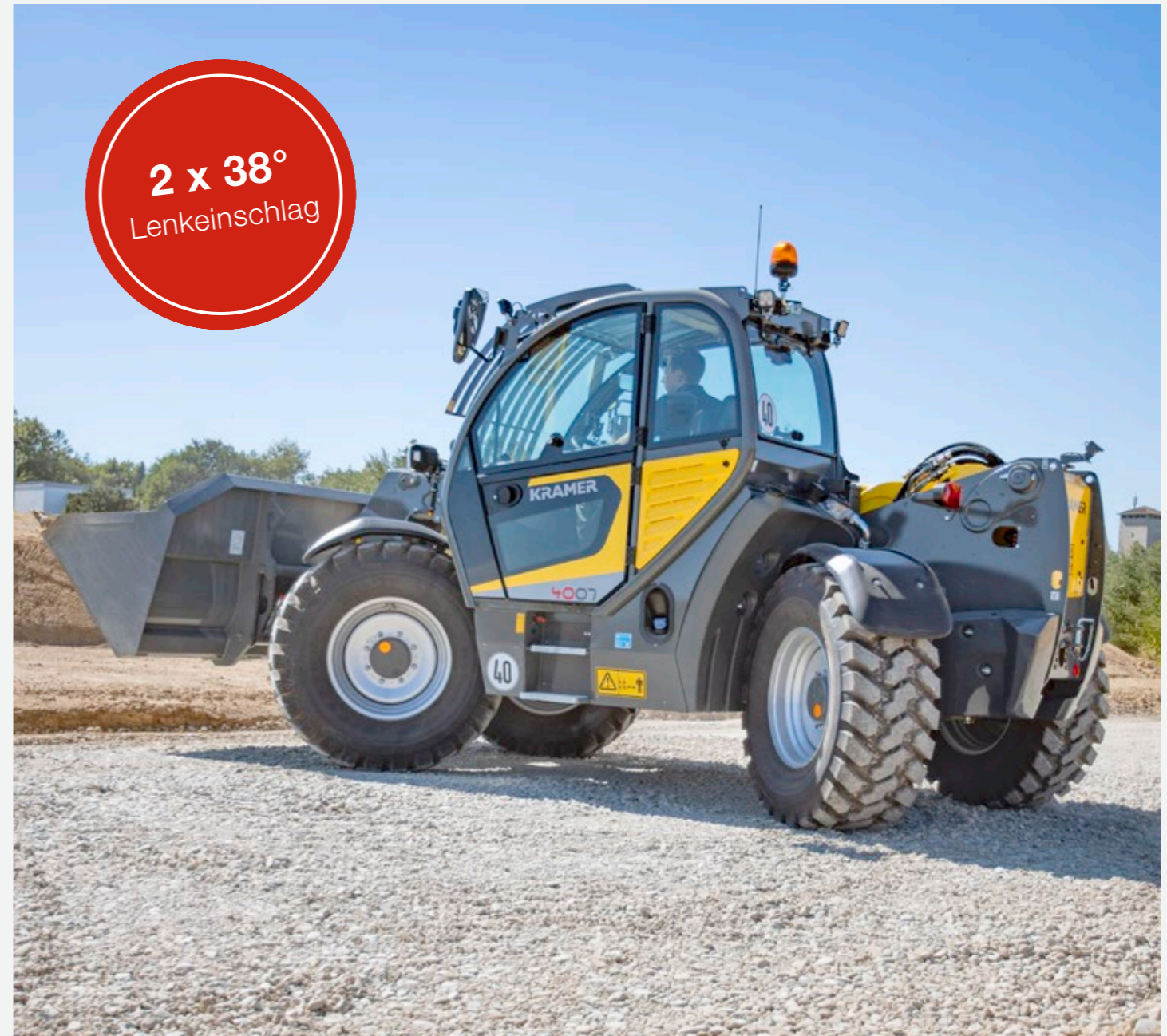
Allradlenkung: besonders wendig bei eingeschränktem Platz
