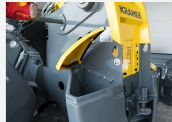
Staufach in den Heckgewichten beim 4507 - 5509
