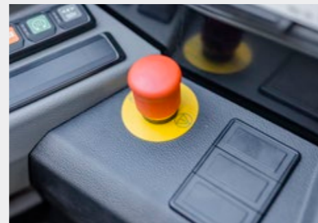
Schnell erreichbarer Notausschalter, damit die Maschine im Gefahrenfall sofort in einen sicheren Zustand versetzt werden kann.
