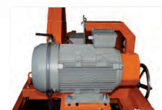
Leistungstarker 7,5 kW Antriebsmotor
