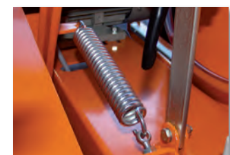
Gefederter Schneidkopf für stufenlose Höhenverstellung
