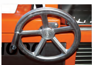
Sägeblattvorschub mittels Handrad
