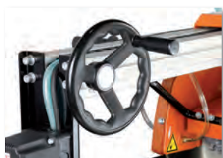
Sägeblattvorschub mittels Handrad
