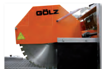
Scheibendurchmesser 650 mm (260 mm Schnitttiefe)
