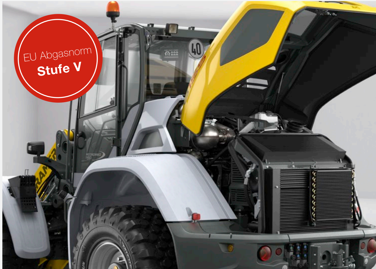
Wassergekühlter 4-Zylinder Reihenmotor mit gekühlter externer Abgasrückführung, Turboaufladung sowie Ladeluftkühlung.
